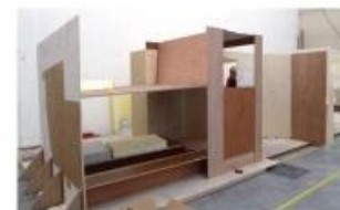
Maqueta a tamaño real de la Pardo 50 para comprobar los detalles de ergonomía, espacios, proporciones y otros aspectos.
