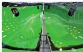
Preparación de molde y molde girado para facilitar la laminación. La tercera imagen muestra una cubierta en infusión al vacío.
