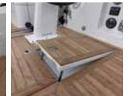
Tra i dettagli di pregio, questi pratici puntapiedi a pedana. Sotto c'è l'imbarco del carburante, per non macchiare il teak in caso di sversamento
