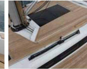
La posizione sulla tuga della rotella per il genoa avvantaggia un punto di scotta più interno liberando al contempo i passavanti. La scotta passa interna al carter
