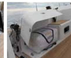
Il gavone sotto la panca di sinistra è organizzato per aprirsi completamente, dando accesso all'autogonfiabile senza doverla estrarre
