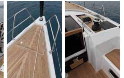
L'aspetto imponente del puntale di prua arricchisce la coperta. Il musone, attaccato più basso, è indipendente. Il drizzista può lavorare in posizione corretta sulla batteria di stopper. La ghigliottina si ripiega sulla soglia
