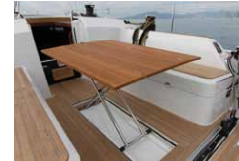
Il tavolo giace su un alloggio dedicato che ruba poco spazio agli interni. Si tira su manualmente aiutati dalle molle che lo trattengono in posizione alzata. L'unico difetto è che un po' di sporcizia si insinua nella fessura tra le ante chiuse
