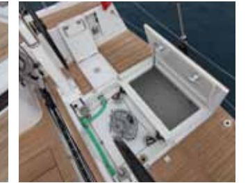
Il grande gavone di poppa si sviluppa su tutta la larghezza. Dal pozzetto si accede anche al settore del timone. Da notare l'imbarco gasolio sotto il puntapiedi
