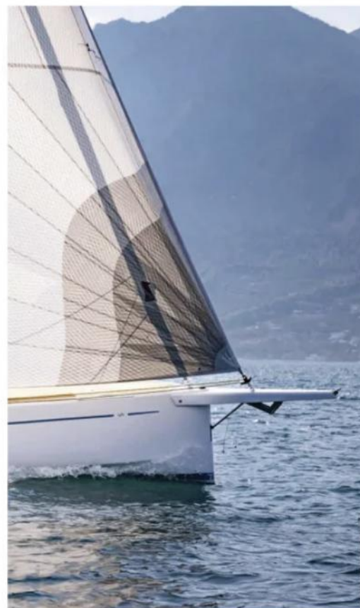
On distingue bien la quille à bulbe en «T» (qui plonge à 2,20 m) et le safran encore plus allongé... Tout ce qu'il faut pour s'amuser sous voiles!
