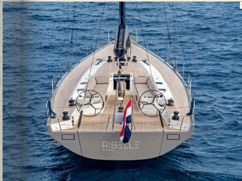
4. Con sus dos winches de drizas a pie de palo y los cofres de estiba de cabos, el tejadillo de la caseta queda totalmente despejado.
