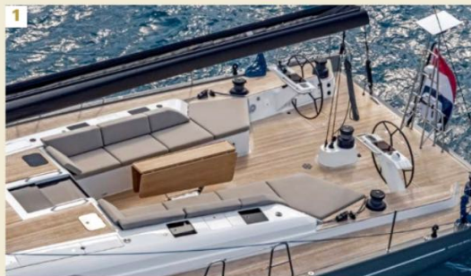
1. La bañera se divide en dos áreas funcionales: la de estar y la de trabajo. Un winche central controla la escota de mayor.
