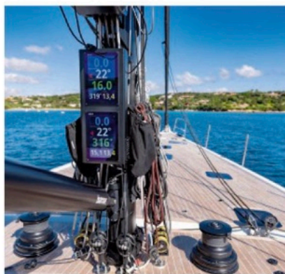
Die großen B&G-Displays am Mast sind von jeder Crewposition aus ablesbar.
