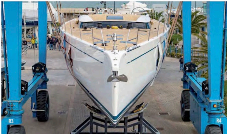
Il varo del Grand Soleil 80 ci mostra una barca con una sezione anteriore a V e volumi di poppa a sbalzo.
