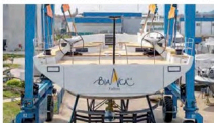
Il varo del Grand Soleil 80 ci mostra una barca con una sezione anteriore a V e volumi di poppa a sbalzo.
